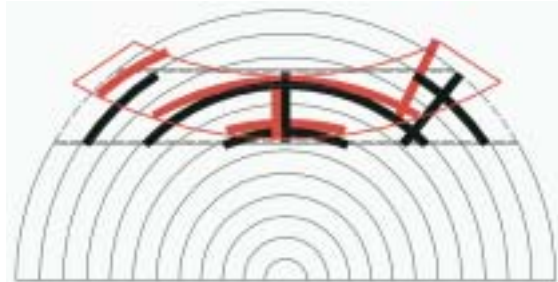
Esquema en el que se representan las deformaciones radial y tangencial en una tabla de madera tras el proceso de secado.
