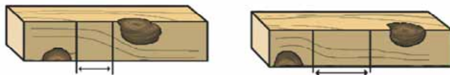
Distribución da fibra en nós agrupados (esquerda) e nós illados (derecha)
