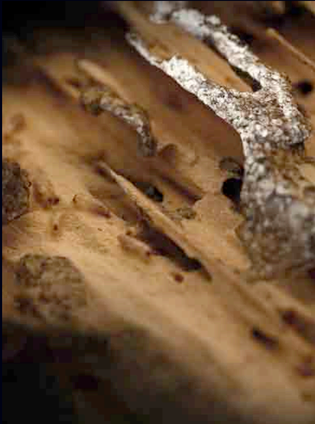
Na imaxe ampliada vense varias obreiras de térmites así como a estrutura típica feita na madeira atacada. A cor das obreiras e branquecina coas mandíbulas claramente destacadas.
